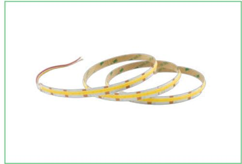
Tunable White COB LED-Streifen mit 640 LEDs/m, 24 V und variabler Farbtemperatur von 2700 K bis 6000 K. Auch in IP65. Individuelle Längen auf Anfrage.
